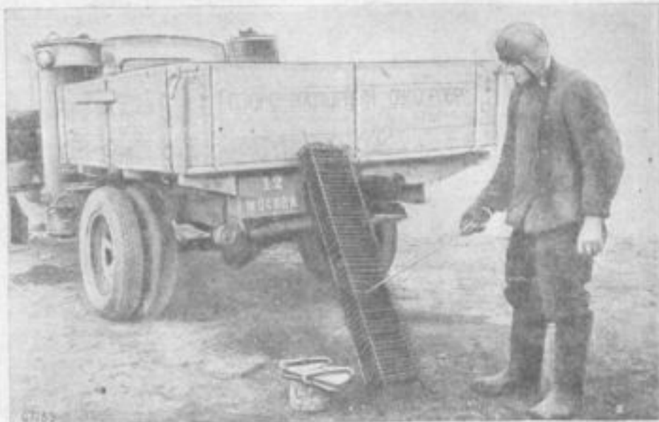
Рис. 2. Чистка батарей охладителей-очистителей
